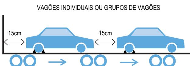
2. Em vagões totalmente formados, entre os carros, para-choques para para-choques, ou para-choques para estrutura fixa do vagão: nada menos que 10 cm
